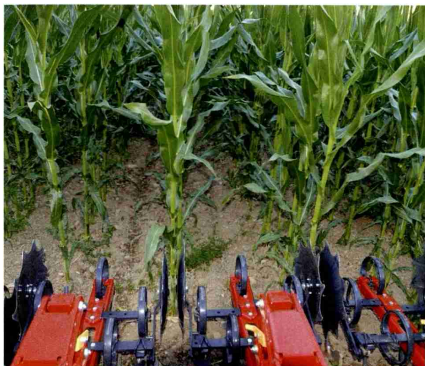
Bandspritzung: Ein Bodenherbizid hält den Bestand innerhalb der Reihen sauber. Das Hackgerät säubert zwischen den Reihen.
