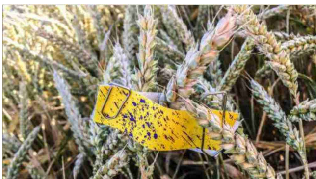
Wassersensitives Papier zeigt die Benetzung. (Bild: mb)
