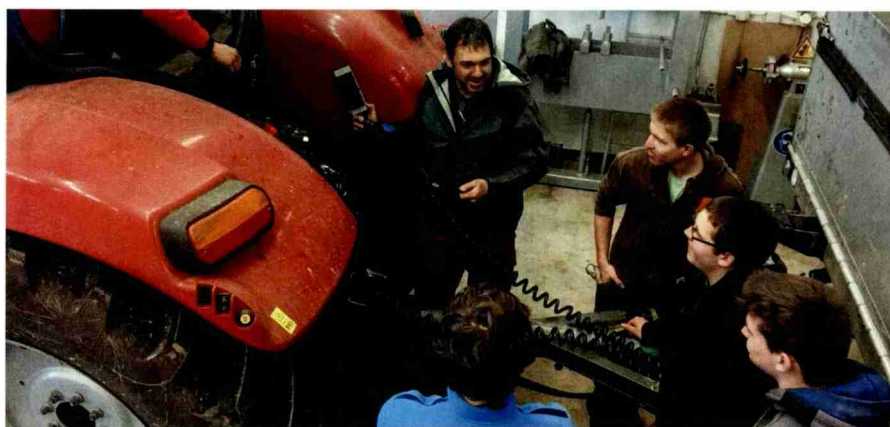
Stefan Beugger, Instruktor am Strickhof und gelernter Landmaschinenmechaniker, erklärt den Lernenden am Strickhof, warum ein Spannungswandler für einen Anhänger mit «EBS»/«ABS» notwendig ist. Bild: S. Berger
