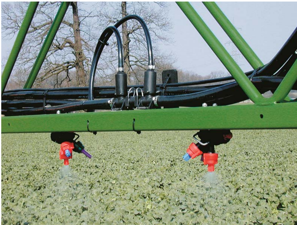
Grosse Tropfen der Injektordüsen vermindern die Abdrift. Injektordüsen sind heute Standard, sie gehören an jede Spritze! (Bildquelle: Amazone)
