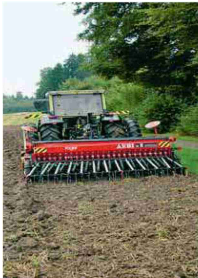
Doppeltbereifte Landwirtschaftsgeräte wirken durch die bessere Gewichtsverteilung der Bodenverdichtung entgegen. Quelle: FaBo
