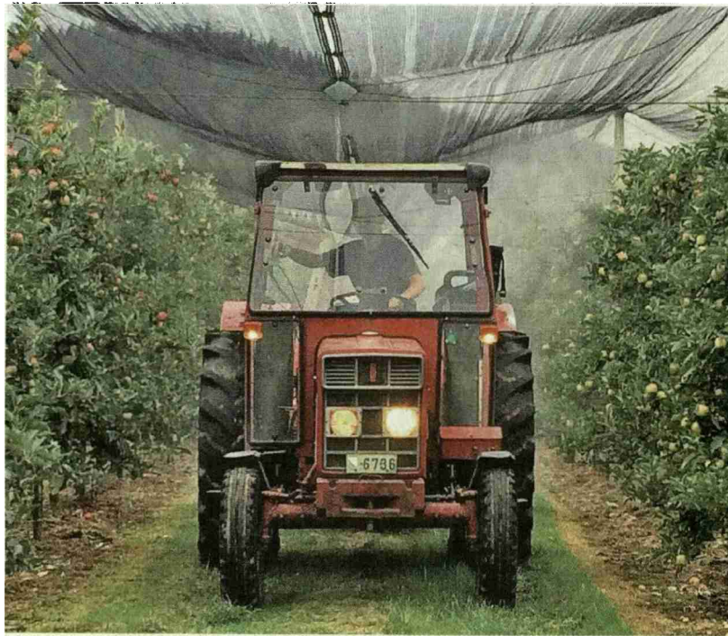
Sprühgerät in Aktion: Sprühnebel rechts mit Hohlkegeldüsen, links mit abdriftreduzierenden Düsen
