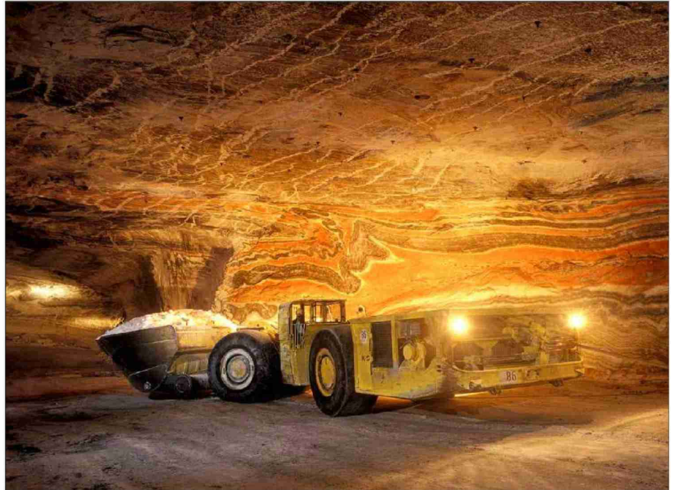
Ein Kalilader transportiert das Salz unter Tag ab. (Bilder: K + S)
